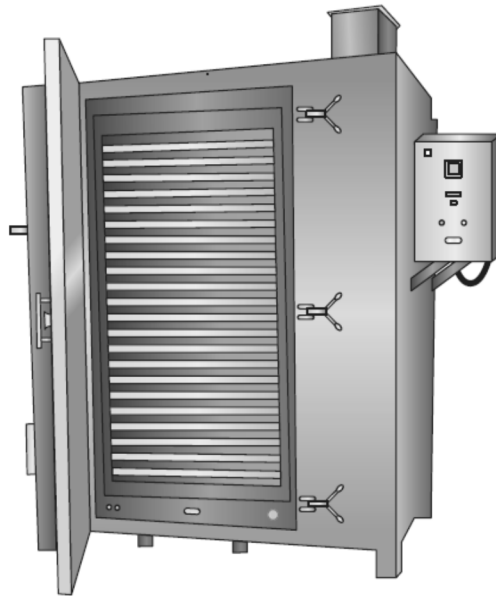
Рис. 16. Промышленная установка для сушки влажных гранул
