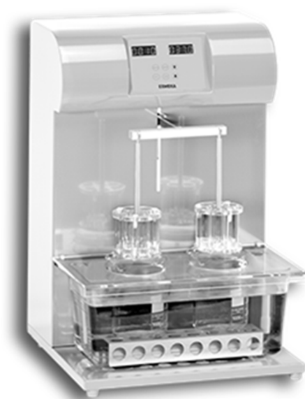
Рис. 25. Прибор для проведения теста на распадаемость («качающаяся корзинка»)
