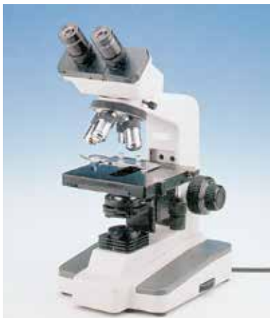
39-сурет. Қазіргі заманғы оптикалық микроскоп (1500-2000 есе үлкейтеді).
